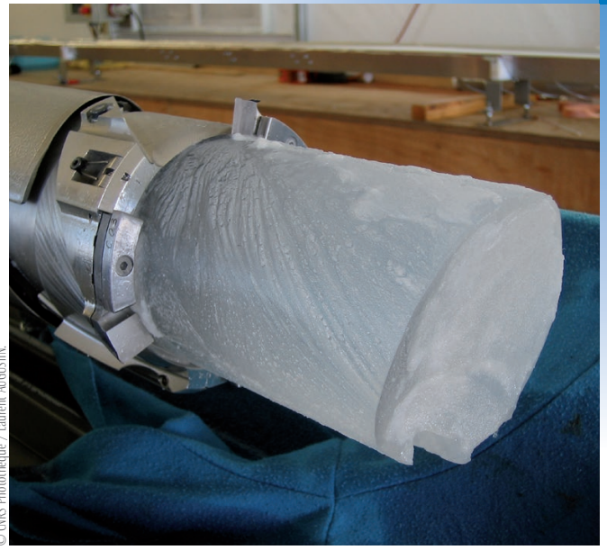
3. Carotte de glace, à la sortie de la tige de forage, extraite dans le cadre du programme EPICA, au Dôme C sur la base franco-italienne Concordia, en Antarctique.
